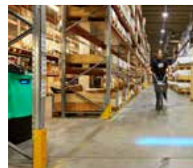
Luz de seguridad de punto azul hacia dirección de accionamiento (horquillas atrás).
