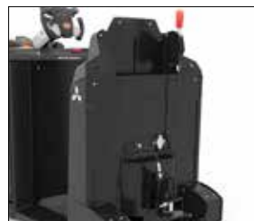
Acoplamiento automático con manija ergonómica de desaseguramiento
